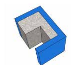
Bloque medio Jamba cortado en la obra
