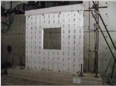
Arriba: Ensayo sísmico en una pared sólida ISOTEX Izquierda: Ensayo sísmico en un muro ISOTEX de dos pisos Derecha: Ensayo sísmico en muro ISOTEX con ventana
