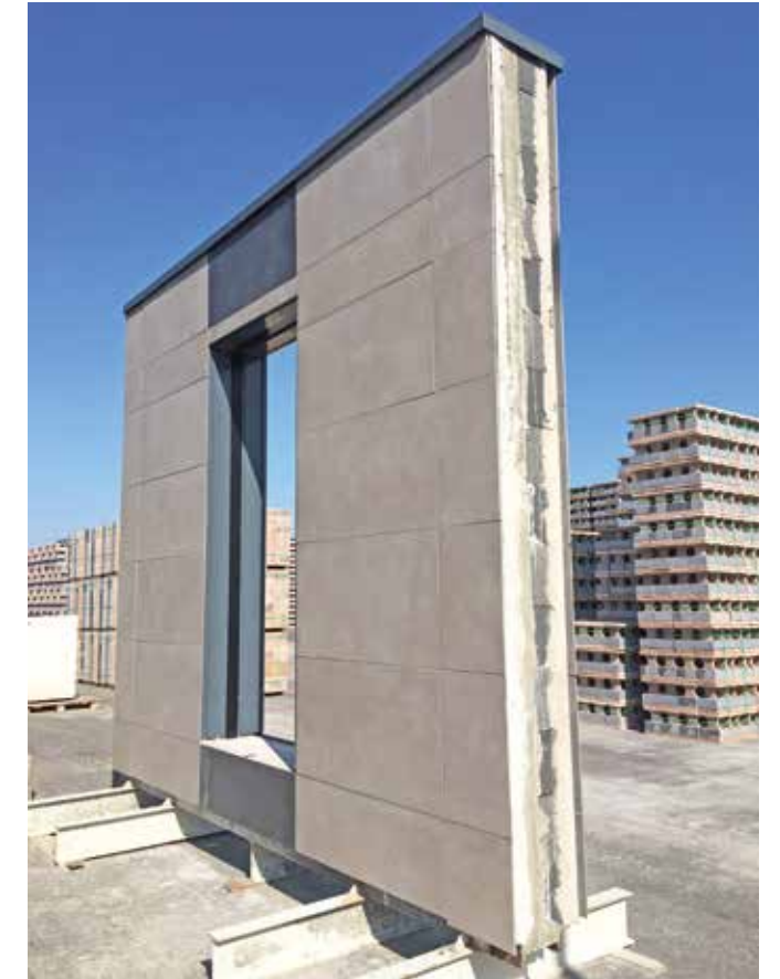
Lato esterno con rivestimento in ceramica e lato interno con parete ventilata
