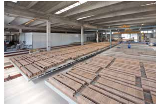
Produzione pannelli solaio
