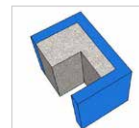
Bloque medio Jamba cortado en la obra
