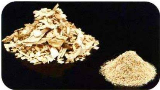
La viruta de madera se obtiene del reciclaje de palés y residuos de las serrerías, se tritura hasta alcanzar la textura y tamaño deseado y se somete a un tratamiento mineralizante, manteniendo intactas sus propiedades mecánicas, a la vez que se detienen los procesos de deterioro biológico.
